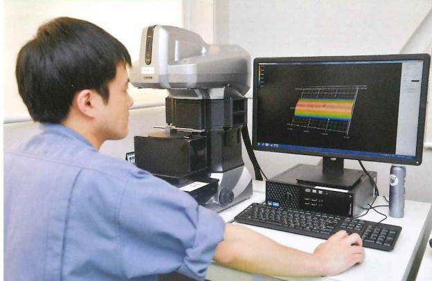
ものづくり補助金を使って導入したNC旋盤(上)と非接触式3D形状測定器。
